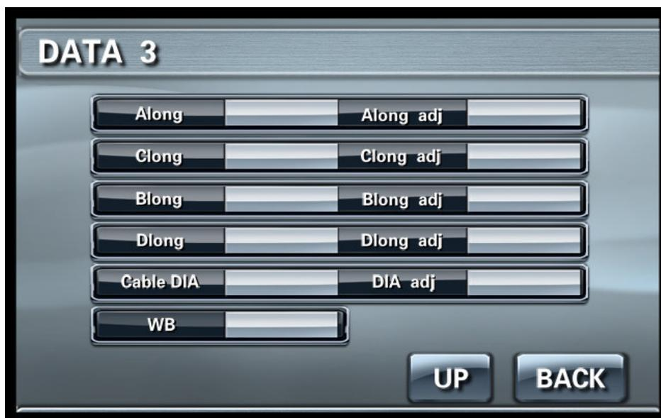
前端剥头长度： 设定前端剥头长度
